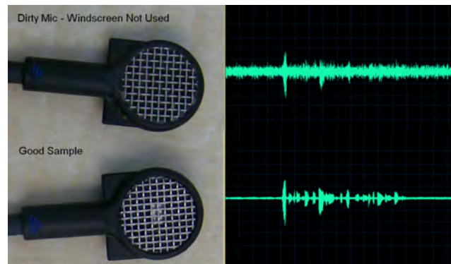
数字 100: 弄脏的麦克风会造成设备性能下降
