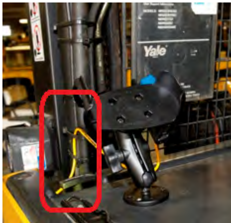
数字 67: 固定在车辆上的电缆
