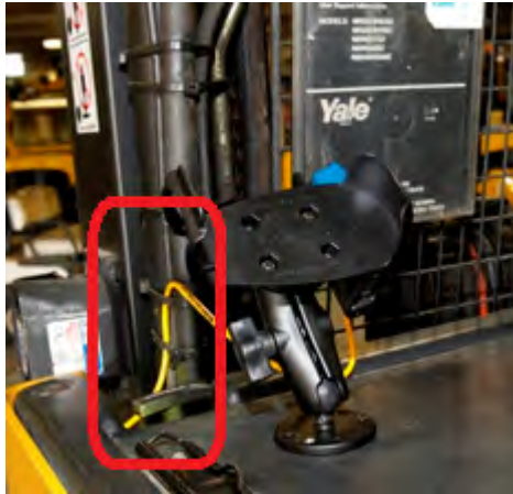
数字 33: 固定在车辆上的电缆
