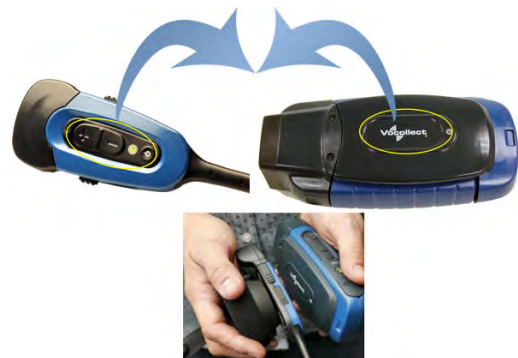
数字 122: 使用 TouchConnect 将 SRX2 与 A700 设备进行配对
