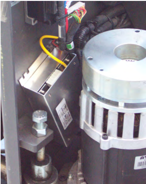
数字 62: 系附于仪表板下方固定表面的电源
