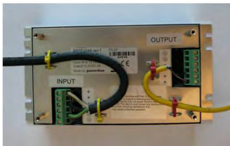
数字 15: 连至设备电源的电缆
