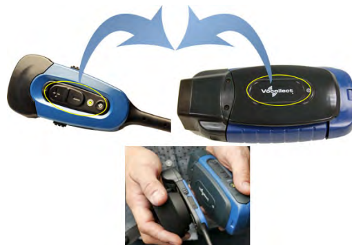
รูปที่ 27: การใช้ TouchConnect เพื่อจับคู่ SRX2 กับอุปกรณ์ A700
