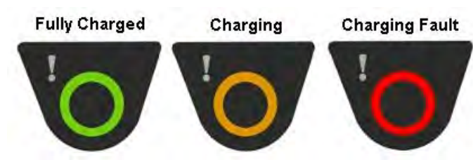
รูปที่ 31: ไฟแสดงสถานะพอร์ทแบตเตอรี่
