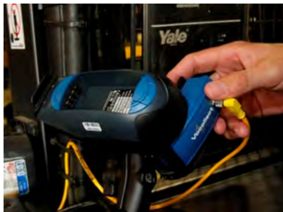
รูปที่ 18: อะแดปเตอร์แบตเตอรี่เชื่อมต่อในการกำหนดค่า VMT
