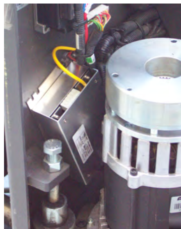
รูปที่ 16: แหล่งจ่ายไฟซึ่งยึดติดกับพื้นผิวที่ปลอดภัยบนยานพาหนะ
