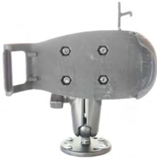
Slika 27: Navojna montaža pomoću držača za montažu u vozilu BL-710-1
