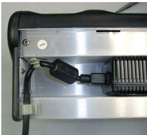
Slika 77: Kabl sproveden kroz plastične stezaljke
