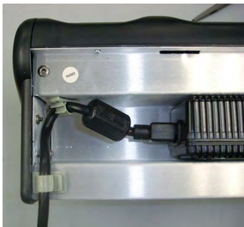
Slika 91: Kabl sproveden kroz plastične stezaljke
