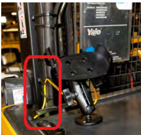
Рисунок 24: Кабели, закрепленные на автомобиле
