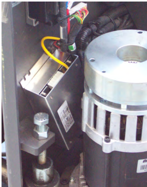
Рисунок 19: Блок питания, прикрепленный к прочной поверхности в транспортном средстве
