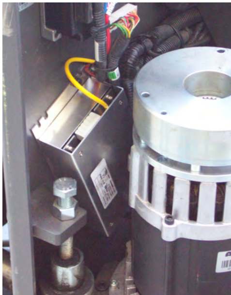
Рисунок 42: Блок питания, прикрепленный к прочной поверхности в транспортном средстве
