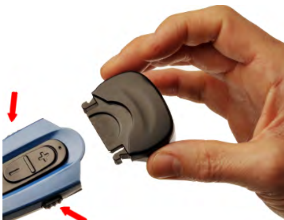
Рисунок 62: Защелки для извлечения батареи SRX2
