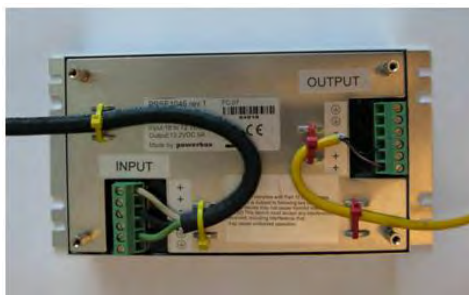
Рисунок 15: Кабели, присоединенные к блоку питания
