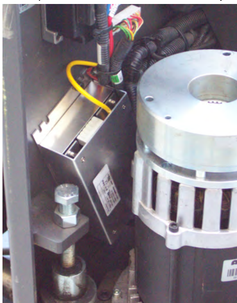
Рисунок 16: Блок питания, прикрепленный к прочной поверхности в транспортном средстве
