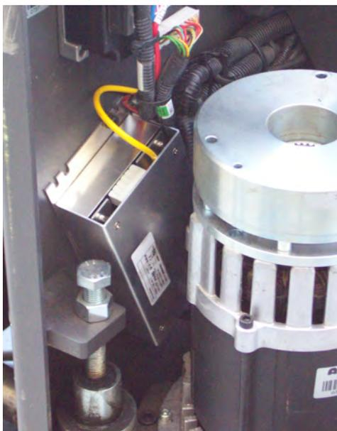
Figura 16: Fonte de alimentação presa a uma superfície segura sob um painel
