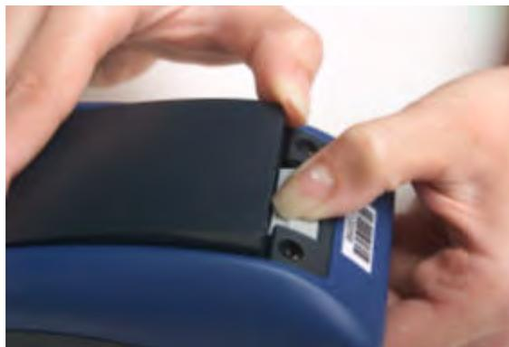
Figura 6: Como remover a bateria de um dispositivo
