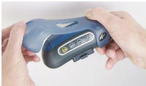
Figura 25: Como colocar uma tampa em um dispositivo Talkman série T5
