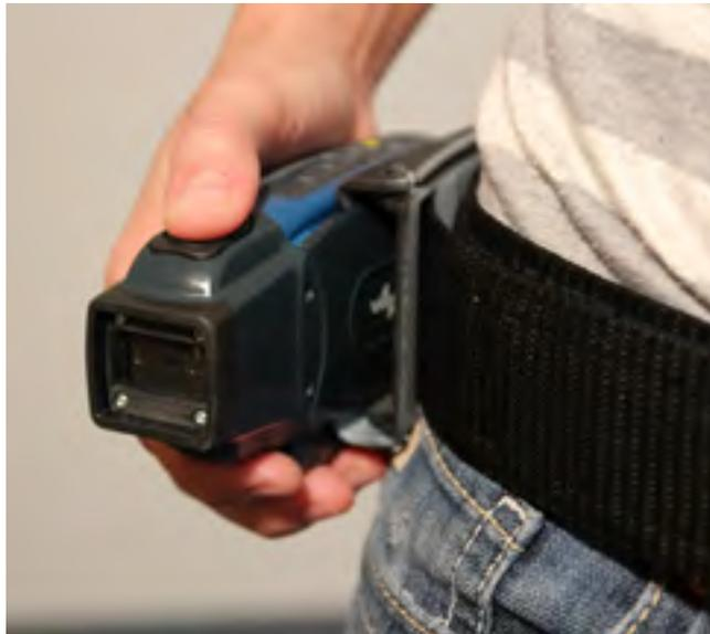
Figura 11: O coldre de dispositivo leitor do A730
