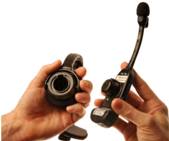
Figura 112: Como conectar o módulo eletrônico
