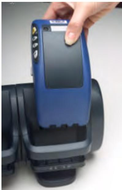
Figura 77: Como inserir um dispositivo da série T2 em um carregador
