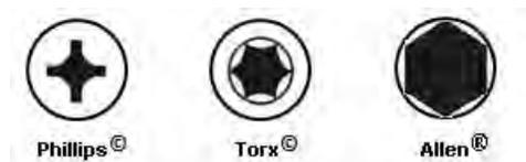
Figura 93: Diversos tipos de cabeça de parafuso da presilha do fio da tiara
