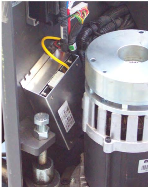
Figura 28: Fonte de alimentação presa a uma superfície segura sob um painel
