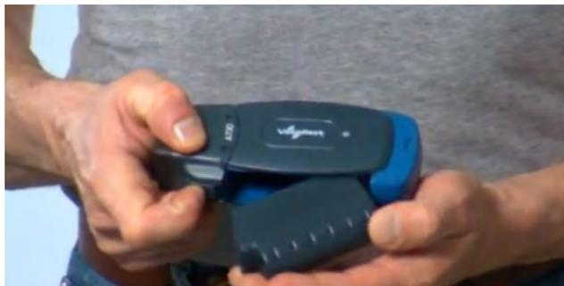
Figura 3: Como remover a bateria de um dispositivo
