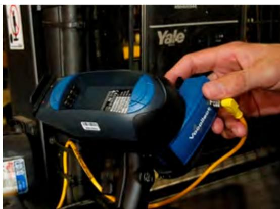
Figura 64: Adaptador de bateria encaixado na configuração VMT
