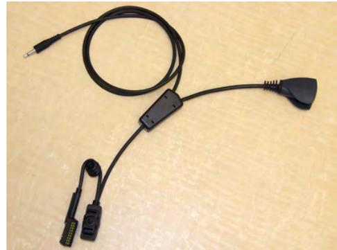
Figura 158: Cabo de treinamento Honeywell LXE HX2
