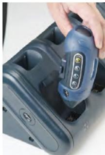
Figura 78: Como remover um dispositivo de um carregador
