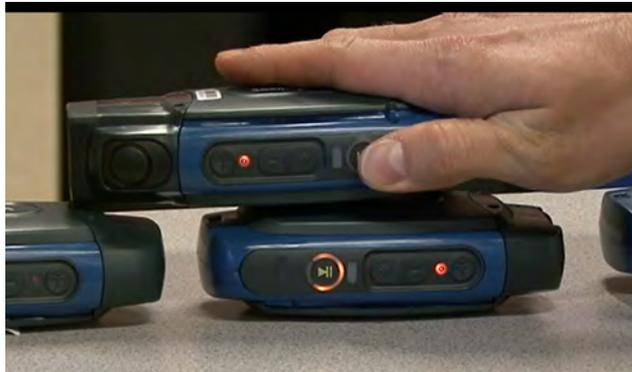
Figura 5: Transferência da configuração usando TouchConfig
