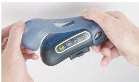
Figura 45: Como colocar uma tampa em um dispositivo Talkman série T5
