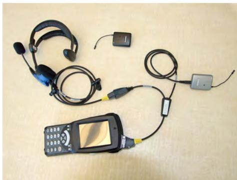
Figura 161: Configuração do cabo de treinamento comum
