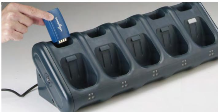
Figura 49: Como inserir uma bateria no carregador
