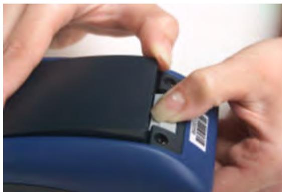
Figura 52: Como remover a bateria de um dispositivo
