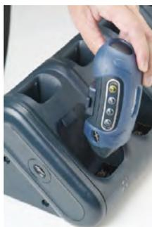
Figura 16: Como remover um dispositivo de um carregador
