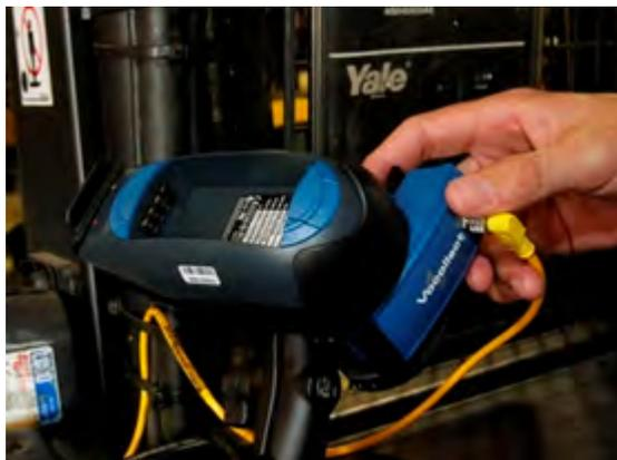
Figura 30: Adaptador de bateria encaixado na configuração VMT
