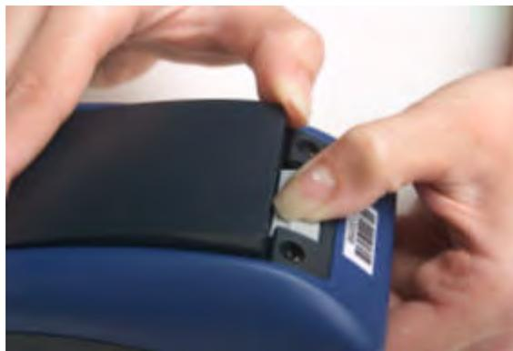
Figura 80: Como remover a bateria de um dispositivo
