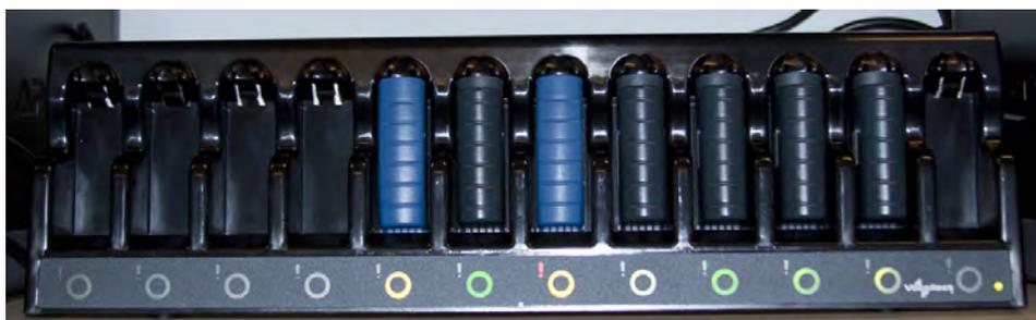
Figura 127: Carregador de bateria de A700 de 12 compartimentos
