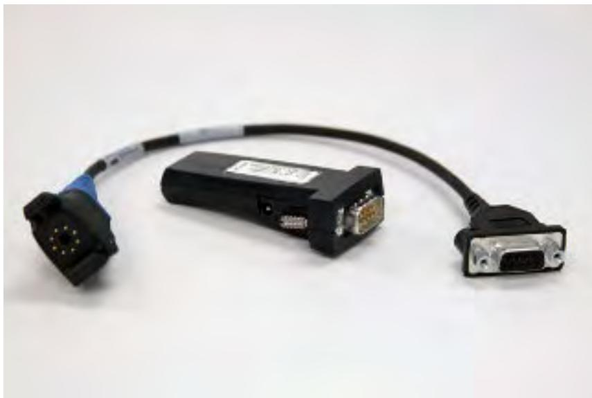
Figura 85: Adaptador serial Bluetooth para T2x
