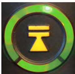
Figura 4: Segmentos do anel no indicador de estado do dispositivo
