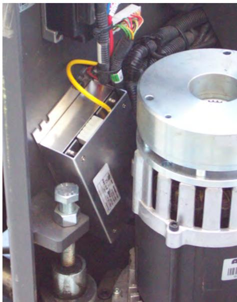
Figura 62: Fonte de alimentação presa a uma superfície segura sob um painel
