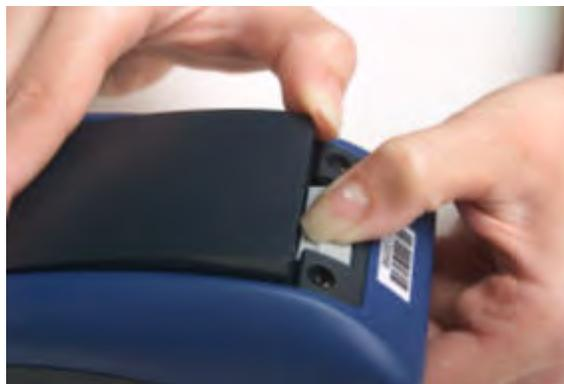
Figura 18: Como remover a bateria de um dispositivo
