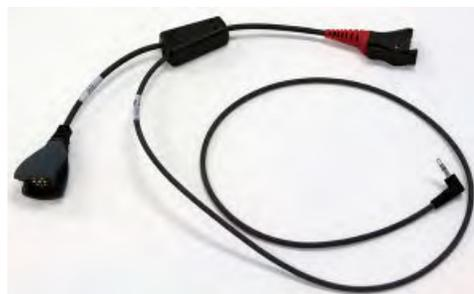
Figura 156: Cabo de treinamento (TR-603-102) para Talkman, scanner com fio e kit de audição
