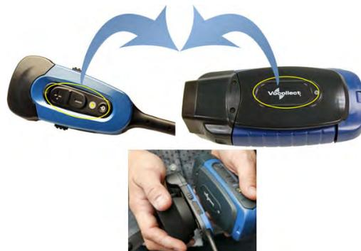
Figura 122: Como usar o TouchConnect para emparelhar um SRX2 com um dispositivo A700
