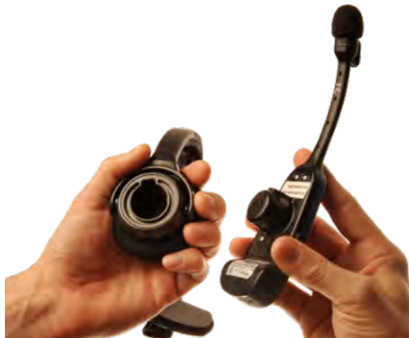
Rajah 6: Memasang modul elektronik
