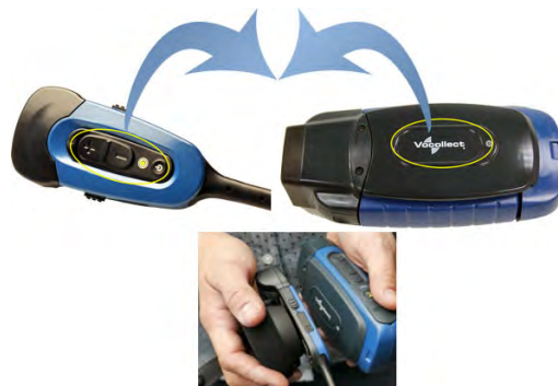
Rajah 68: Menggunakan TouchConnect untuk Memasangkan SRX2 dengan Peranti A700 Device
