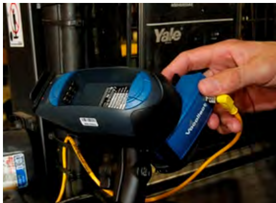
Rajah 29: Penyesuai bateri ditempatkan dalam konfigurasi VMT
