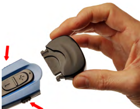
Rajah 47: Selak Bateri untuk Mengeluarkan Bateri SRX2
