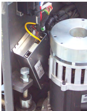
Rajah 27: Bekalan Kuasa Dipasang pada Permukaan Kukuh Kenderaan
