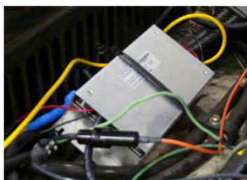
Attēls 19: Barošanas avots, kas nostiprināts pie drošas virsmas zem paneļa
