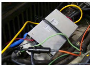
Attēls 37: Barošanas avots, kas nostiprināts pie drošas virsmas zem paneļa
