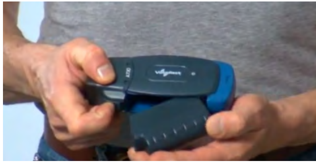
Attēls 3: Akumulatora izņemšana no ierīces
