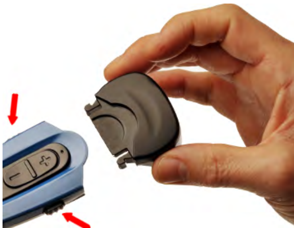
Attēls 52: Akumulatora fiksatori SRX2 akumulatora izņemšanai
