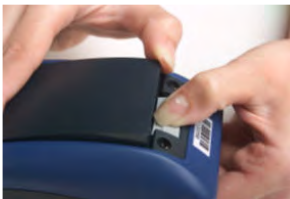
Attēls 9: Akumulatora izņemšana no ierīces
