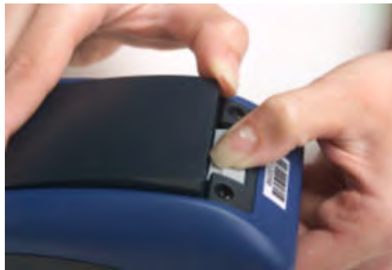
Attēls 27: Akumulatora izņemšana no ierīces
