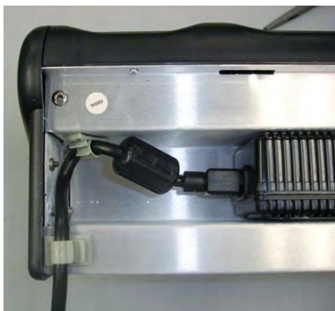
72 pav.: Kabelis nutiestas per plastikinius spaustukus
