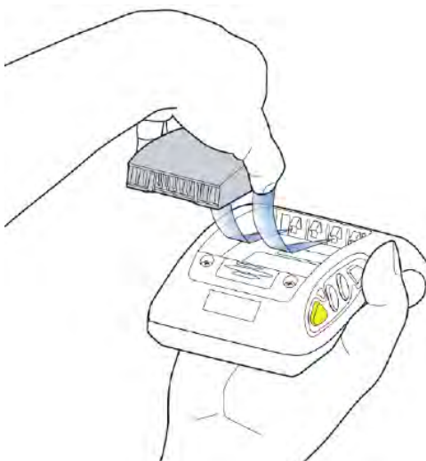
26 pav.: Tinkamas baterijos įdėjimas
