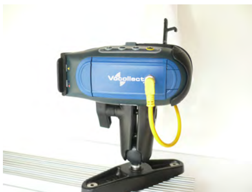
16 pav.: Sraigtais tvirtinamas laikiklis
