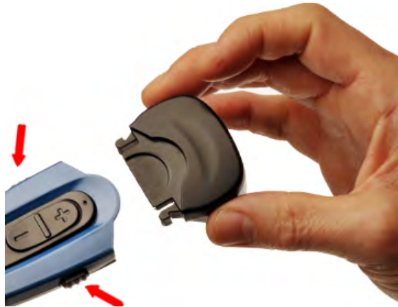
그림 50: SRX2 배터리를 꺼내기 위한 배터리 래치
