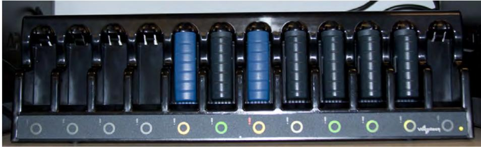
그림 7: A700 12베이 배터리 충전기
