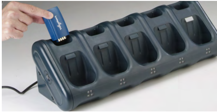
그림 3: 충전기에 배터리 삽입
