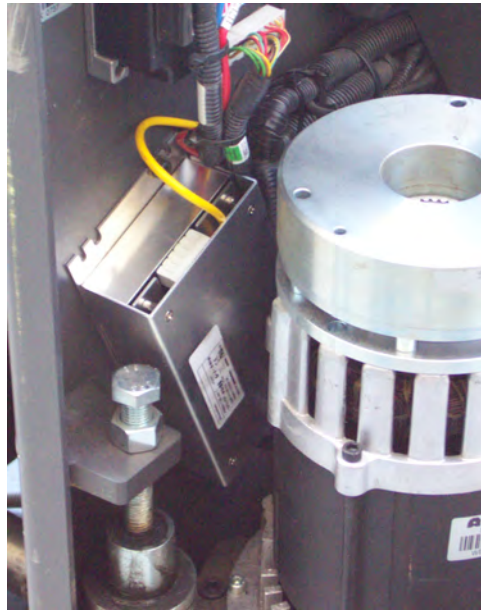
그림 17: 대시보드 아래 고정된 면에 전원 공급 장치 부착
