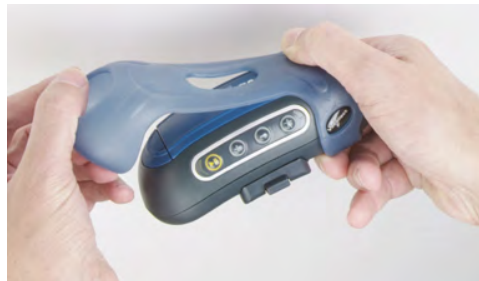
図 30 : T5 シリーズ端末に対するカバー取り付け
