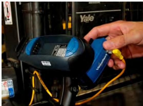
図 30 : VMT構成に取り付けられた電池アダプタ
