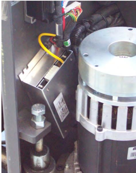
図 62 : ダッシュボードの下にある安全な場所に取り付けられた電源
