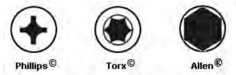
図 93 : ヘッドバンドコードクリップに使用されるネジ頭部頂面の種類
