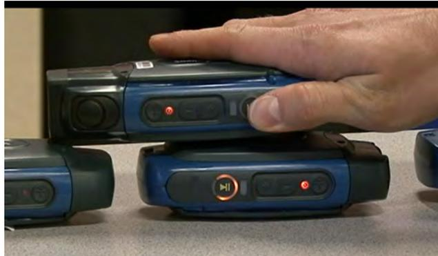
図 5 : TouchConfigを使った設定の転送
