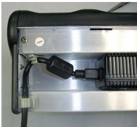
図 156 : プラスチック クリップを通し誘導されたケーブル
