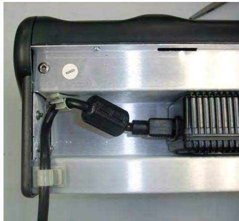
図 143：プラスチック クリップを通し誘導されたケーブル
