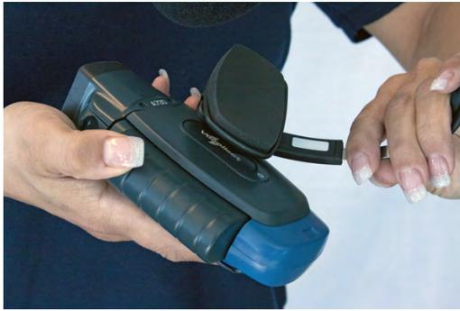
図 134 : TouchConnectを使ってヘッドバンドから作業員情報を取得する
