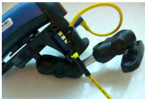
図 34 : ケーブルをしっかりと車両に接続
