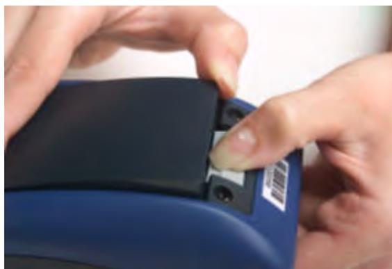
図 18 : 端末からの電池の取り外し
