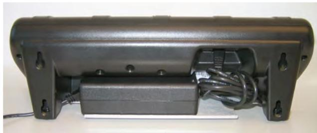
図 159 : 充電器への電源差し込み
