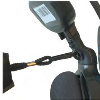
図 106 : ストラップを穴にクリップ留め
