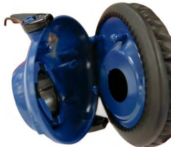
図 132 : イヤークップ部品の取り外し
