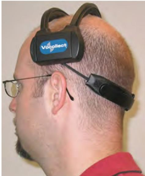
図 107 : モビリティ ストラップの適切な装着
