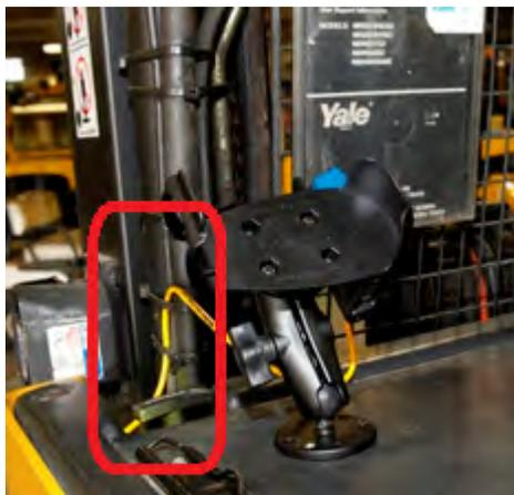
図 33 : ケーブルをしっかりと車両に接続
