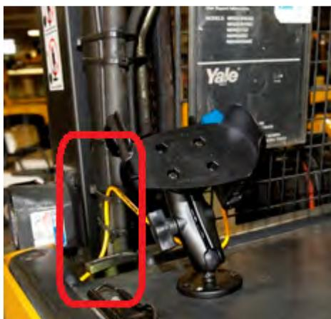
図 67 : ケーブルをしっかりと車両に接続
