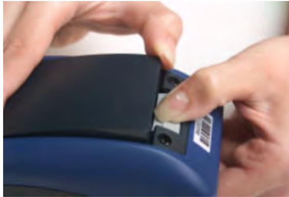
図 80 : 端末からの電池の取り外し
