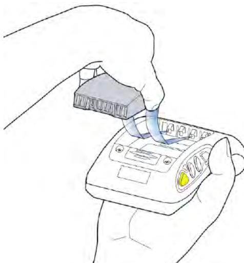
図 17 : 電池の適切な挿入
