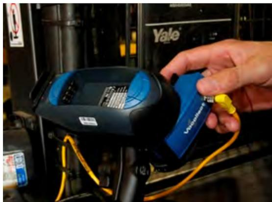
図 64 : VMT構成に取り付けられた電池アダプタ
