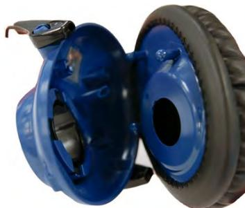
図 129 : イヤークップ部品の取り外し
