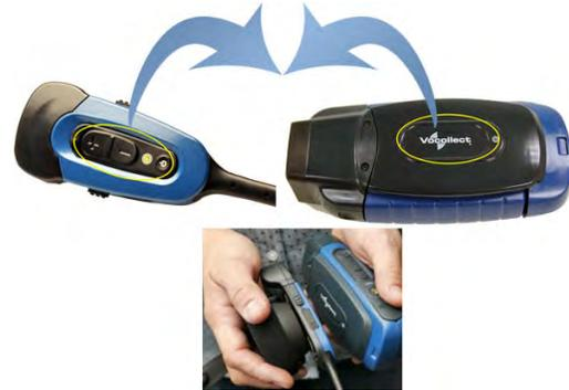
図 135 : TouchConnectを使ってSRX2とA700端末を組み合わせる
