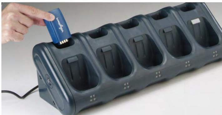
図 49 : 充電器への電池の差し込み
