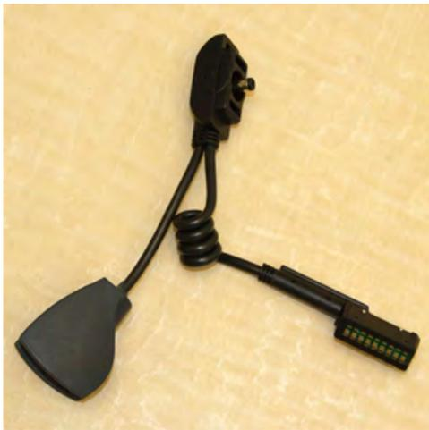
図 173: Honeywell LXE HX2ヘッドセット ケーブル
