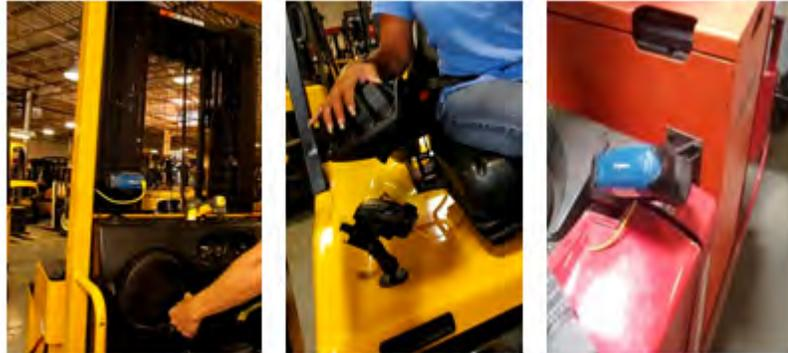
図 65 : 車両により保護され無線受信に支障のない取り付け位置
