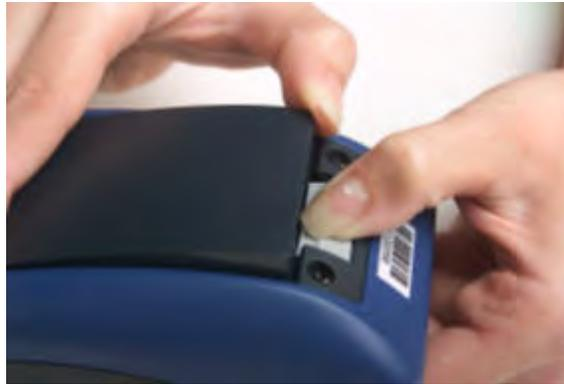
図 52 : 端末からの電池の取り外し
