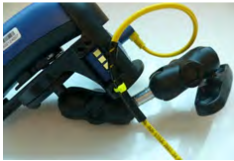
図 22 : ケーブルをしっかりと車両に接続
