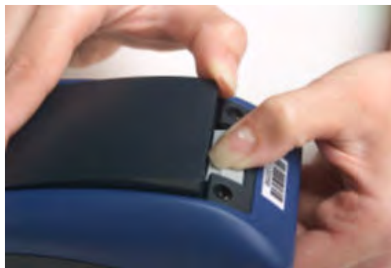
図 6：端末からの電池の取り外し
