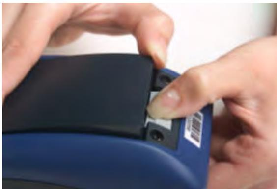
Figura 6: Rimozione della batteria da un dispositivo
