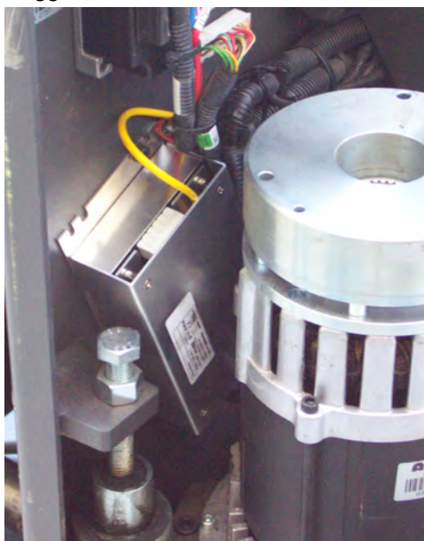
Figura 57: Alimentatore installato su una superficie sicura sotto il cruscotto
