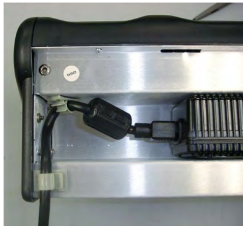
Figura 133: Cavo instradato attraverso le clip di plastica
