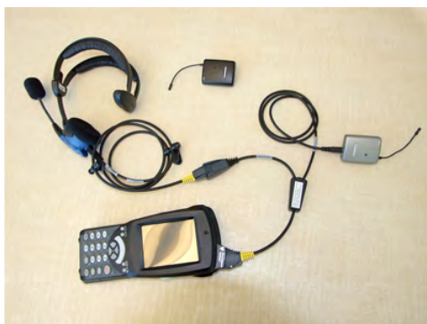
Figura 152: Configurazione tipica del cavo addestramento
