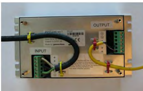
Figura 27: Cavi collegati all'alimentatore
