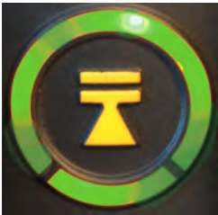
Figura 4: Segmenti dell'anello sull'indicatore di stato del dispositivo
