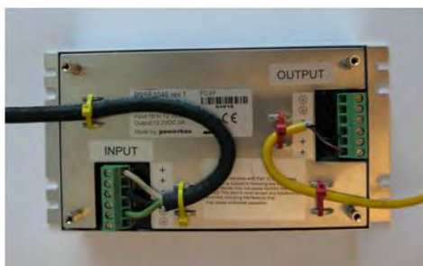
Figura 56: Cavi collegati all'alimentatore
