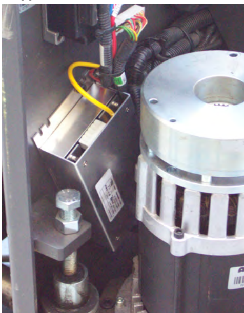
Figura 28: Alimentatore installato su una superficie sicura sotto il cruscotto
