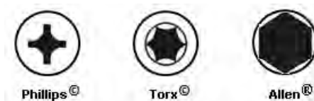
Figura 83: Vari tipi di teste di vite per la clip per cavo cuffia
