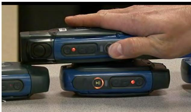
Figura 4: Trasferimento della configurazione mediante TouchConfig
