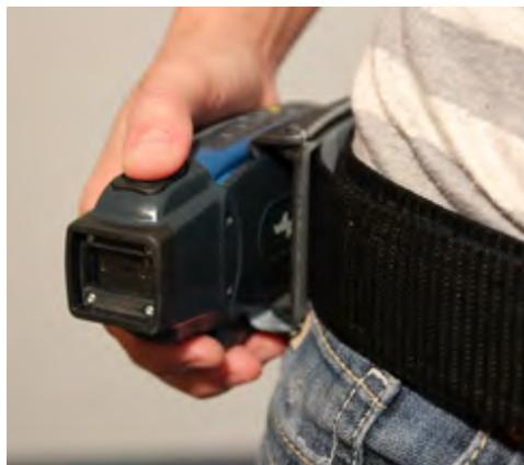
Figura 15: Fondina per dispositivo di scansione A730
