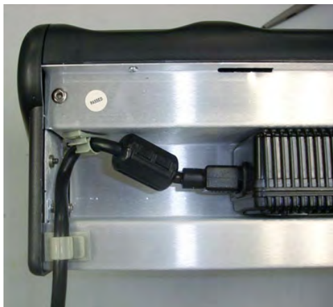
Figura 19: Cavo instradato attraverso le clip di plastica
