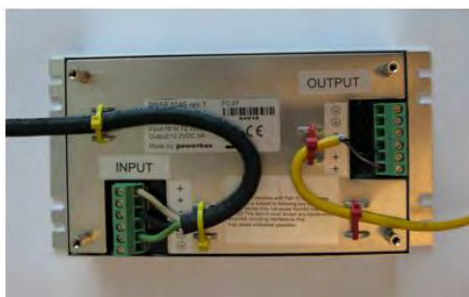
Figura 15: Cavi collegati all'alimentatore
