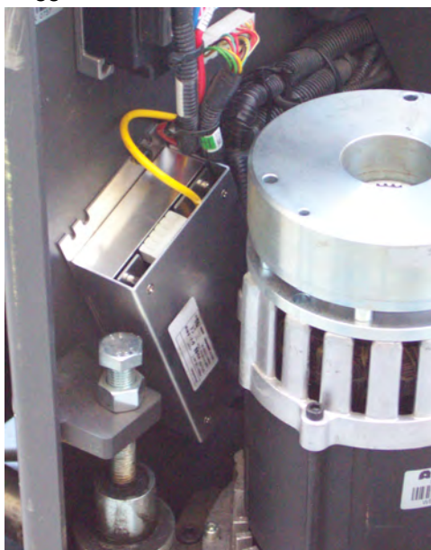
Figura 16: Alimentatore installato su una superficie sicura sotto il cruscotto
