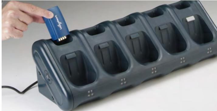
Gambar 37: Memasukkan Baterai ke dalam Pengisi Daya
