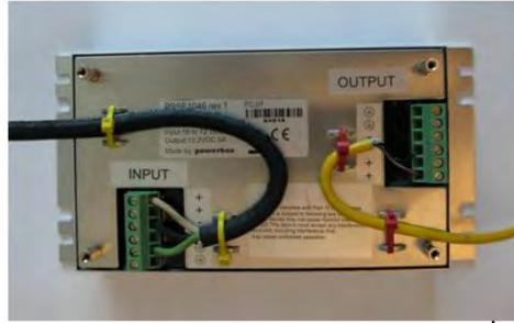
Gambar 50: Kabel yang Tersambung ke Catu Daya
