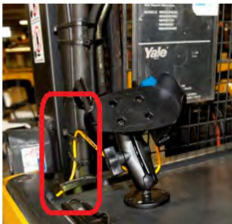
**Gambar 32: Kabel dipasang dengan baik di kendaraan**
