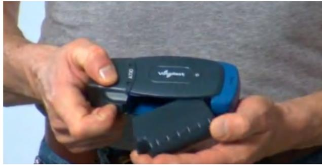
Gambar 3: Uklanjanje baterije iz uređaja
