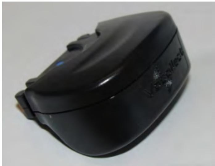
Gambar 74: Baterai Kinerja Tinggi Headset Nirkabel SRX2
