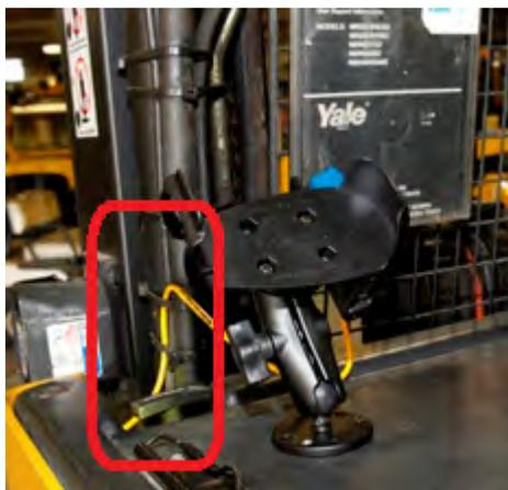
**Gambar 56: Kabel dipasang dengan baik di kendaraan**
