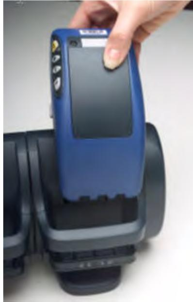
Gambar 60: Memasukkan Perangkat Seri-T2 ke Dalam Pengisi Daya
