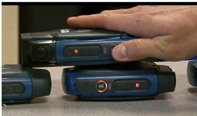
Gambar 5: Mentransfer Konfigurasi Menggunakan TouchConfig
