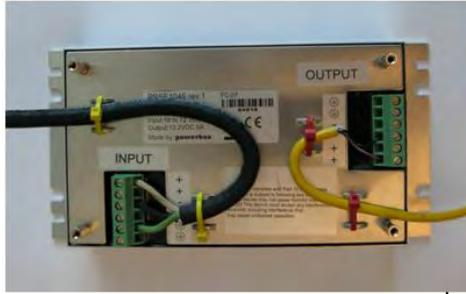
Gambar 26: Kabel yang Tersambung ke Catu Daya
