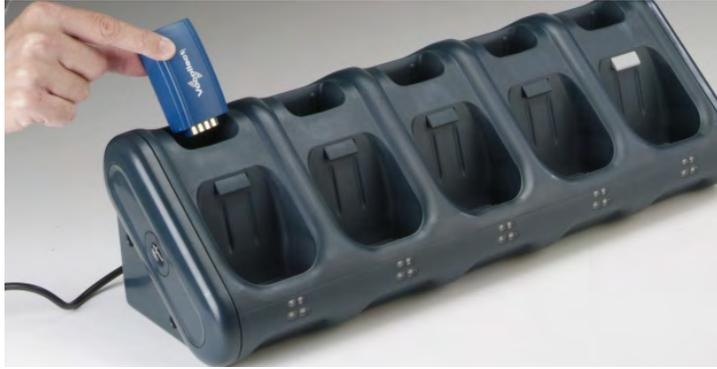
Gambar 13: Memasukkan Baterai ke dalam Pengisi Daya
