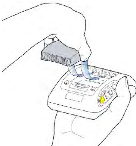
Gambar 15: Memasukkan Baterai dengan Benar
