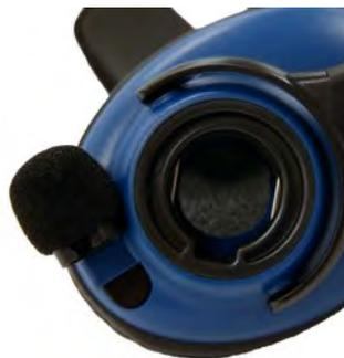
**Gambar 85: Menge-dok-kan tutup mik (Helm SRX2 atau Headset Noise Tinggi)**
