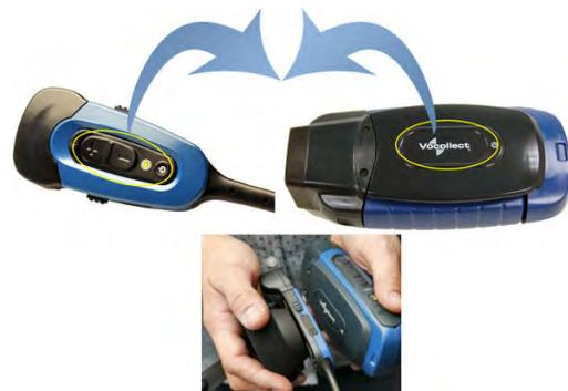
**Gambar 93:** Menggunakan TouchConnect untuk Memasang Headset SRX2 dengan Perangkat A700
