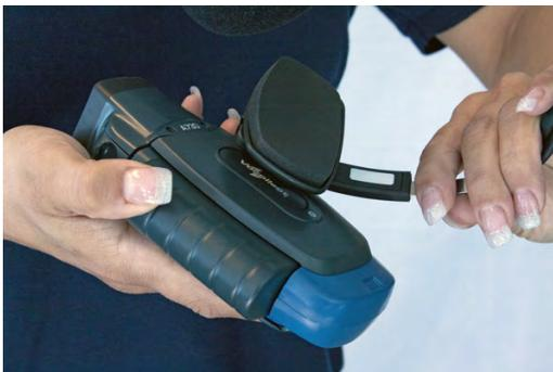
**Gambar 92:** Menggunakan TouchConnect untuk Mendapatkan Informasi Operator dari Ikat Kepala
