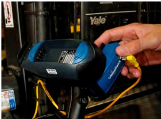
Gambar 29: Adaptor baterai dikaitkan di konfigurasi VMT
