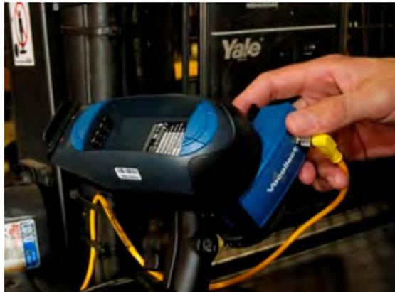
Gambar 53: Adaptor baterai dikaitkan di konfigurasi VMT
