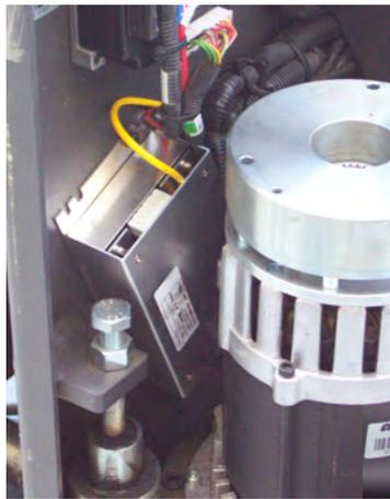
Gambar 27: Catu Daya yang Terpasang ke Permukaan Aman di Kendaraan
