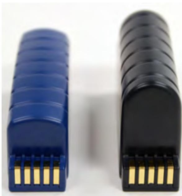
Gambar 2: Baterije standardnog i velikog kapaciteta za Talkman A700
