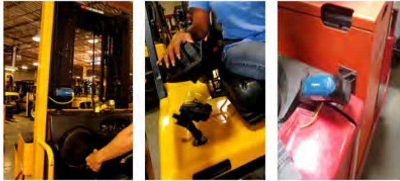
Gambar 54: Lokasi pemasangan yang terlindung di kendaraan tetapi penerimaan nirkabel yang bagus tidak terhalang
