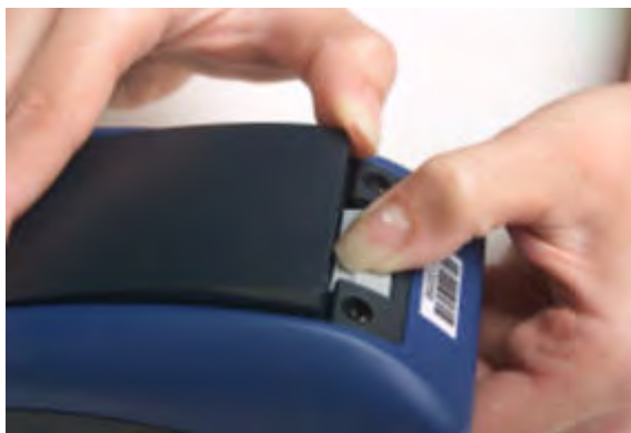
Slika 54: Uklanjanje baterije iz uređaja
