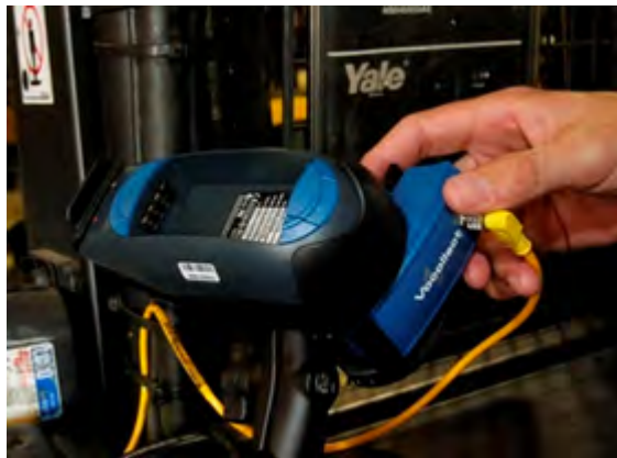
Slika 21: Baterijski adapter u ležištu u VMT konfiguraciji
