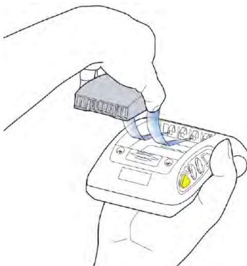
Slika 53: Propisno umetanje baterije
