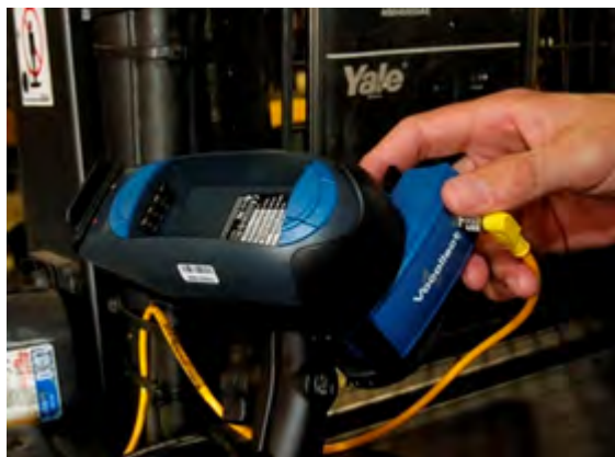
Slika 44: Baterijski adapter u ležištu u VMT konfiguraciji
