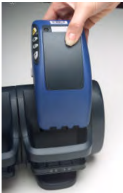
Slika 51: Umetanje uređaja serije T2 u punjač
