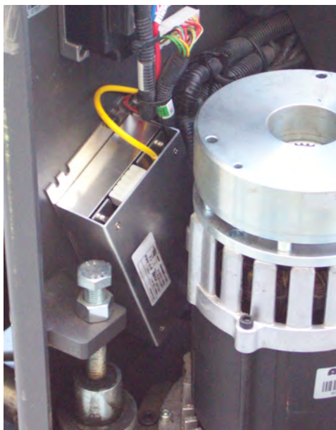
Slika 42: Napajanje pričvršćeno na čvrstu površinu u vozilu
