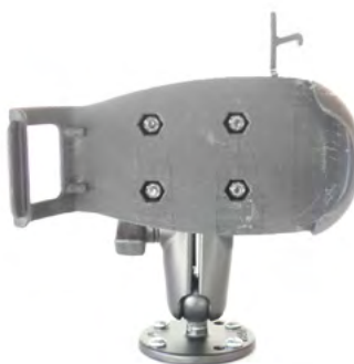
Slika 46: Pričvršćivanje zavijanjem s držačem nosača za vozilo BL-710-1
