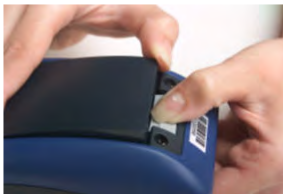
Slika 32: Uklanjanje baterije iz uređaja
