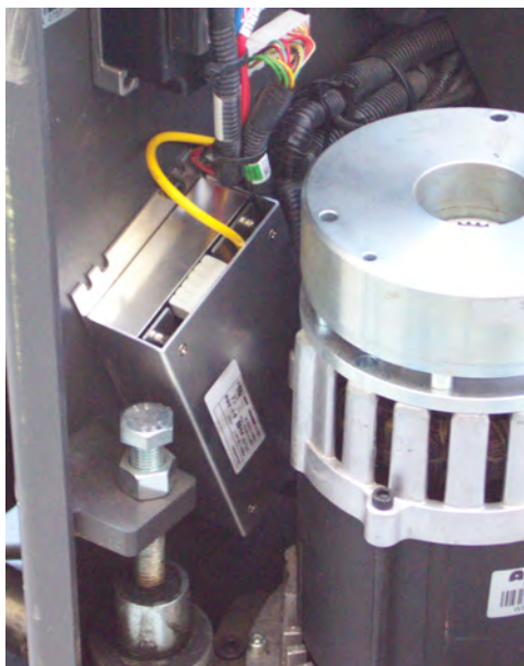
Slika 19: Napajanje pričvršćeno na čvrstu površinu u vozilu
