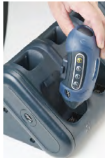
Slika 7: Uklanjanje uređaja iz punjača
