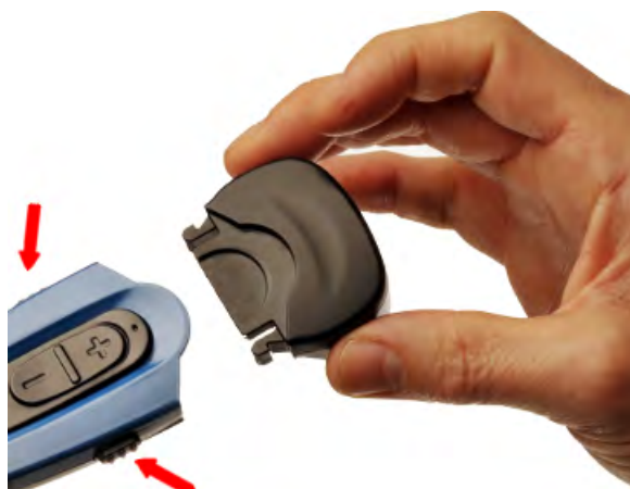
Slika 62: Jezičci baterije za uklanjanje baterije SRX2
