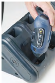
Slika 52: Uklanjanje uređaja iz punjača
