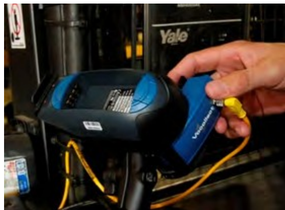
איור 23: מתאם סוללה מעוגן במכלול VMT
