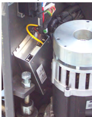
Illustration 16: Alimentation électrique fixée sur une surface stable sous un tableau de bord
