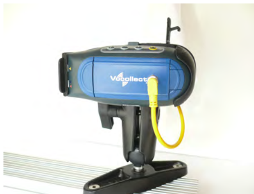
Illustration 14: Montage à bride
