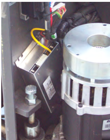
Illustration 28: Alimentation électrique fixée sur une surface stable sous un tableau de bord
