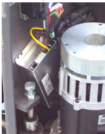
Illustration 57: Alimentation électrique fixée sur une surface stable sous un tableau de bord
