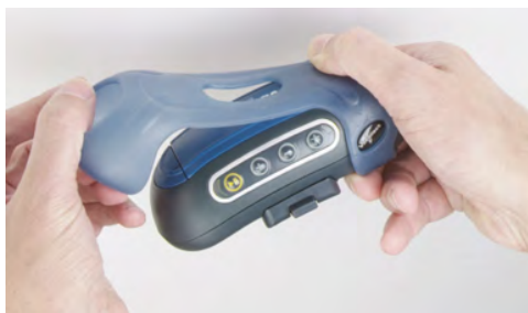
Illustration 64: Mise d'une housse sur un périphérique Talkman de série T5
