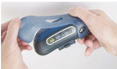
Illustration 40: Mise d'une housse sur un périphérique Talkman de série T5
