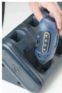
Figura 16: Extracción de un dispositivo de un cargador
