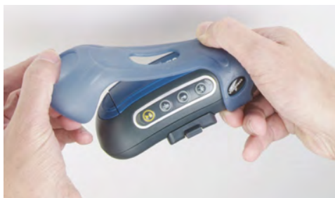
Figura 74: Colocación de una cubierta en un dispositivo Talkman A500/T5
