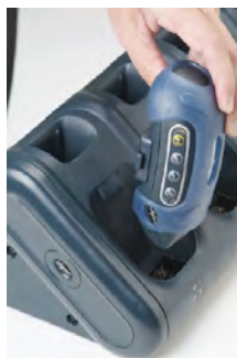
Figura 50: Extracción de un dispositivo de un cargador
