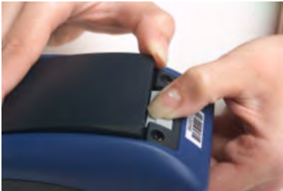
Figura 52: Extracción de la batería de un dispositivo
