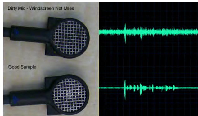
Figura 100: Los micrófonos sucios disminuyen el rendimiento
