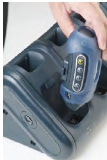
Figura 78: Extracción de un dispositivo de un cargador
