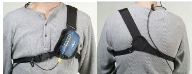
Figura 69: Arnés para hombros de T5/A500 correctamente colocado-Vista frontal y vista posterior
