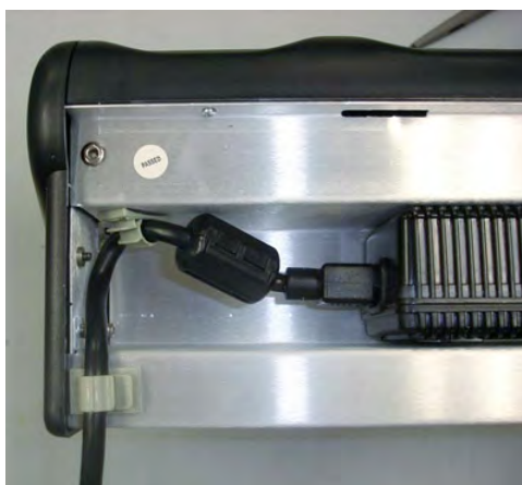
Figura 143: Cable pasado a través de los clips plásticos
