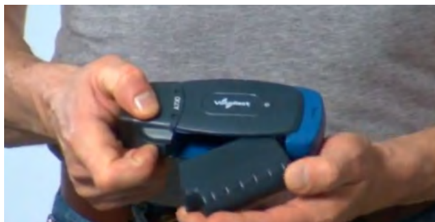
Figura 3: Extracción de la batería de un dispositivo
