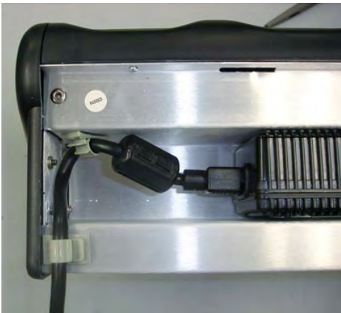
Figura 130: Cable pasado a través de los clips plásticos
