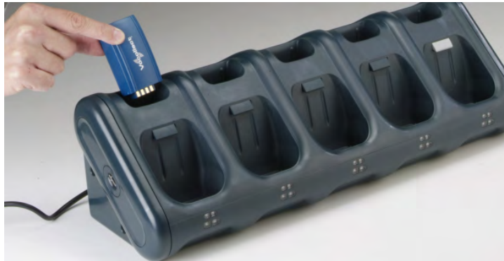
Figura 15: Inserción de una batería en un cargador
