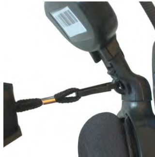
Figura 106: Sujeción de la correa al bucle
