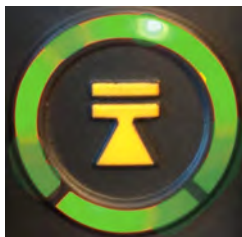
Figura 4: Segmentos anulares en el indicador de estado del dispositivo
