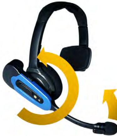
Figura 116: Movimiento del micrófono en su posición correcta
