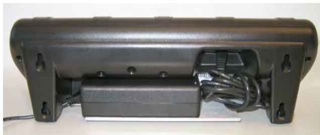
Figura 146: Suministro eléctrico enchufado al cargador
