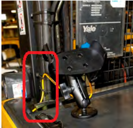
Figura 67: Cables asegurados en un vehículo
