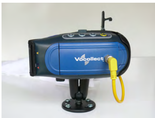
Figura 53: Montaje con tornillos
