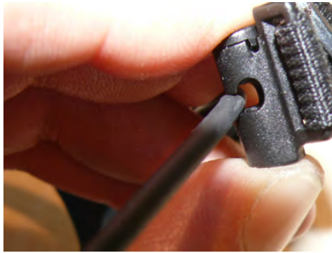
Figura 92: Extracción de la correa ajustable
