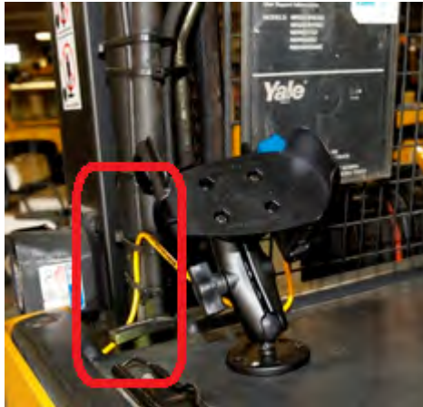
Figura 33: Cables asegurados en un vehículo
