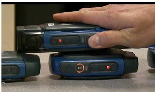
Figura 5: Transferencia de la configuración mediante TouchConfig
