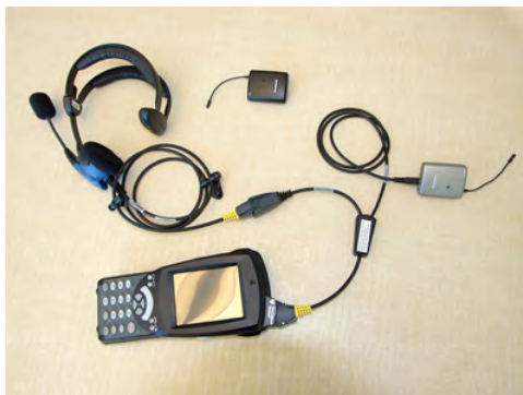
Figura 162: Disposición típica de cable de entrenamiento
