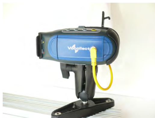
Figura 54: Montaje con abrazaderas
