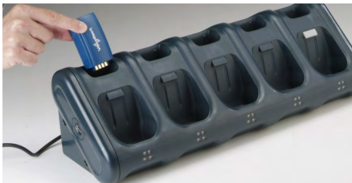
Figura 49: Inserción de una batería en un cargador
