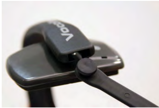
Figura 118: Inserción de la correa en el receptáculo de la vincha
