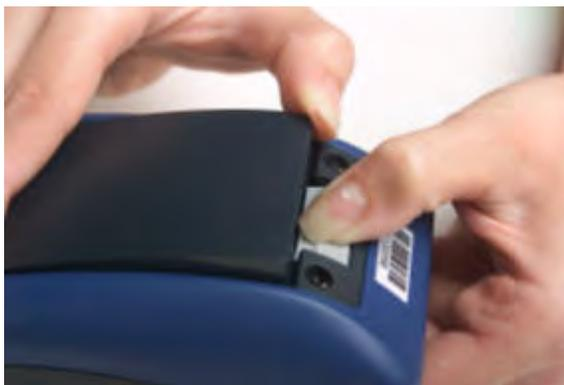
Figura 6: Extracción de la batería de un dispositivo
