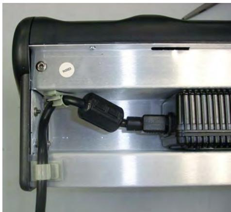
Figura 19: Cable pasado a través de los clips plásticos
