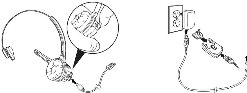
1. Conecte el extremo micro USB del cable en el auricular SRX-SL.
