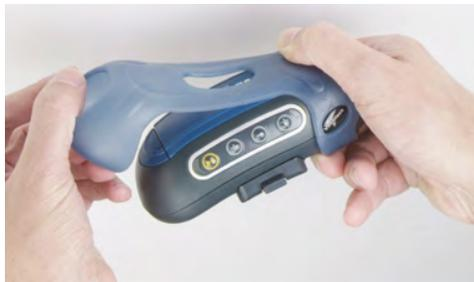
Figura 26: Colocación de una carcasa en un terminal Talkman de la serie T5
