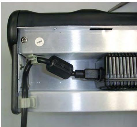
Figura 19: Cable sujeto con clips de plástico
