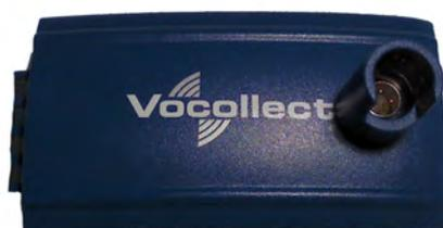
Figura 13: Adaptador de la batería
