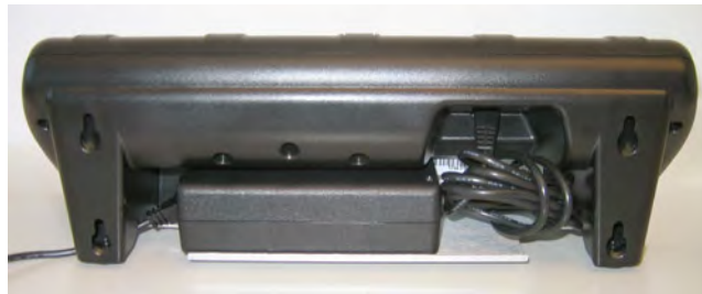
Figura 136: Fuente de alimentación conectada al cargador
