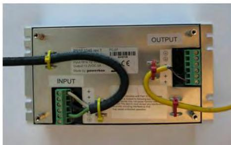
Figura 15: Cables conectados a la fuente de alimentación
