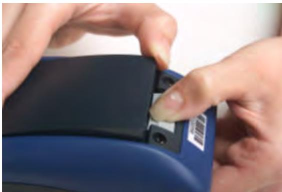
Figura 6: Retirada de la batería de un dispositivo
