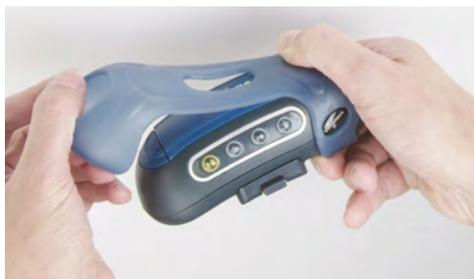
Figura 31: Colocación de una carcasa en un terminal Talkman de la serie T5
