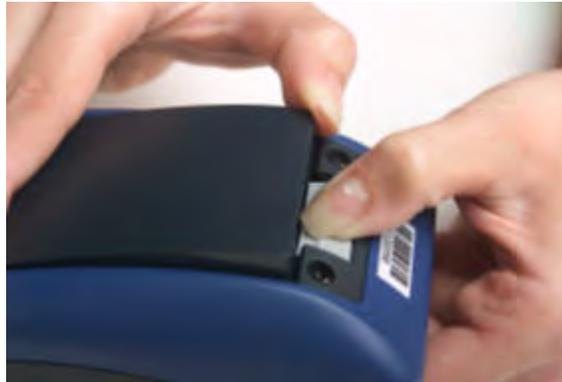
Abbildung 6: Entnahme des Akkus aus einem Gerät
