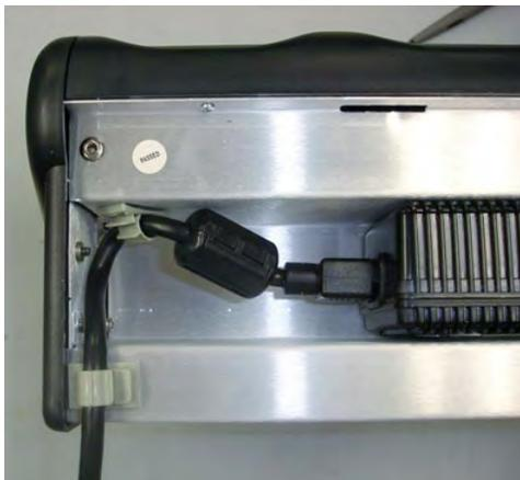
Abbildung 19: Durch Kunststoffklammern befestigtes Kabel
