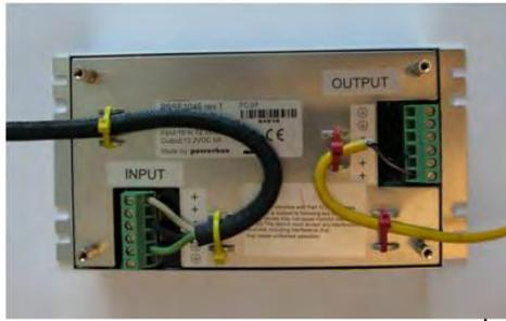
Abbildung 15: An die Stromversorgung angeschlossene Kabel
