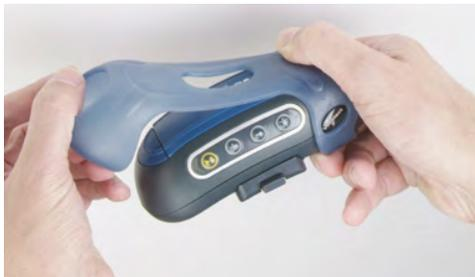
Abbildung 25: Anbringen einer Abdeckung an ein Talkman-Gerät der T5-Serie
