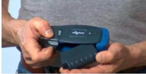
Abbildung 3: Entnehmen des Akkus aus einem Gerät
