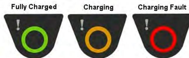
Abbildung 9: Ladegerätsanschluss betreffende LED-Anzeigen
