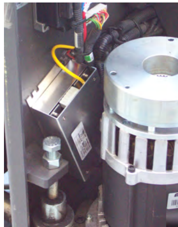
Abbildung 16: Unter einem Armaturenbrett an einer stabilen Oberfläche angebrachte Stromversorgung
