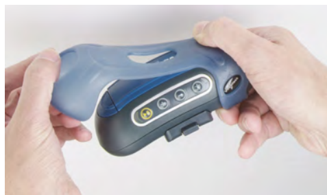
Abbildung 30: Anbringen einer Abdeckung an ein Talkman-Gerät der T5-Serie
