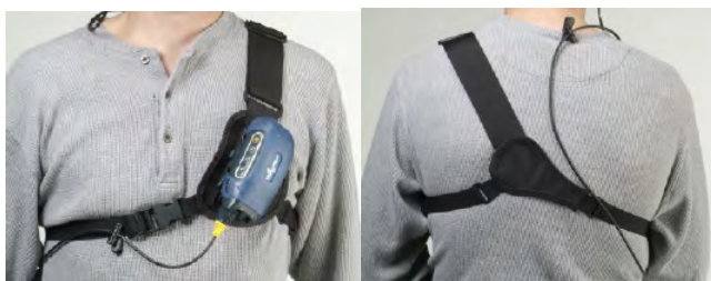
Abbildung 26: Ordnungsgemäß angelegter T5/A500-Schultergurt - Vorderansicht und Hinteransicht
