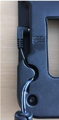
2. Richten Sie die Führungsvorrichtungen an der Unterseite der Ladeeinheit an den Aussparungen der Dockeinheit aus und schieben Sie die Ladeeinheit in die Dockeinheit. Die LED-Anzeige soll dabei in der linken oberen Ecke des Ladegeräts verbleiben.
