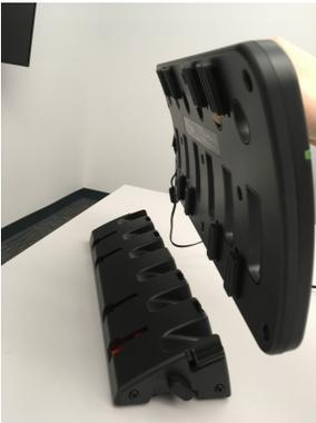
3. Befestigen Sie den Kopfbügelhalter am Ladegerät, indem Sie ihn etwas auseinanderziehen und den Halter an den Führungsvorrichtungen und Aussparungen in der Dockeinheit ausrichten. Die Biegung des Kopfbügelhalters muss bei beiden Zusammenbauvarianten mit der Biegung des Ladegeräts übereinstimmen.
