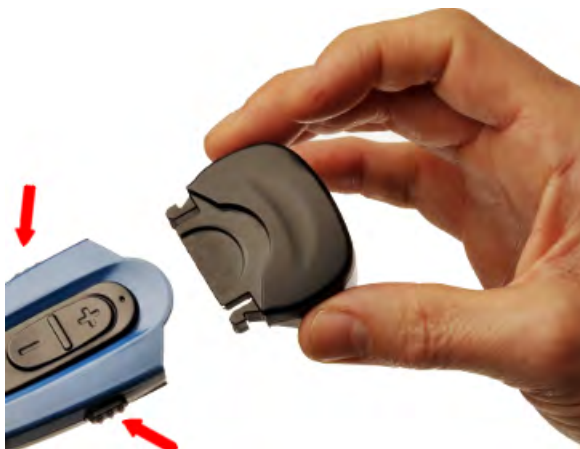
Obrázek 52: Západky baterie pro odstranění baterie SRX2
