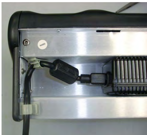
Obrázek 59: Vedení kabelů plastovými svorkami
