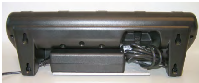
Obrázek 75: Zdroj napájení připojený do nabíječky
