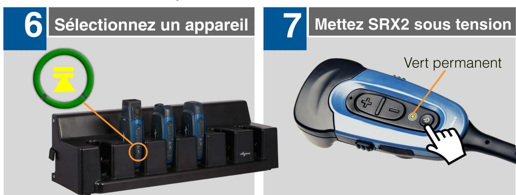
Mettez en contact le module électronique et l'appareil au niveau du symbole
