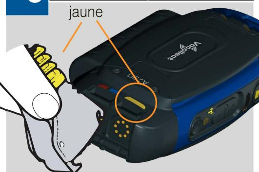
Basculez le connecteur vers l'appareil jusqu'au clic audible
