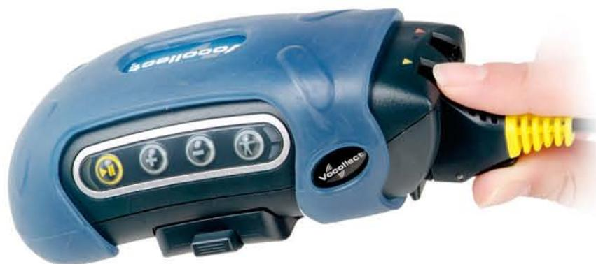
2. Aseta kuulokemikrofoni paikalleen. Aseta mikrofoni suun eteen siten, että varren symboli tulee suuhun päin. Varmista, että mikrofonissa on tuulisuoja.
