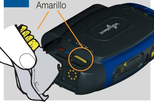
Incline el conector hacia el dispositivo hasta que se fijen
