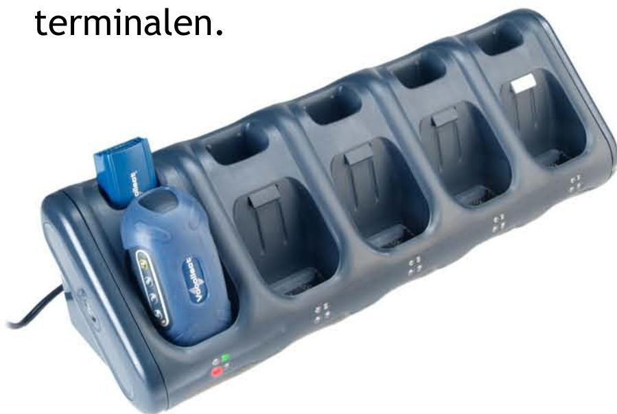
Lysindikatoren blinker rødt og grønt, når terminalen er placeret i en oplader.
