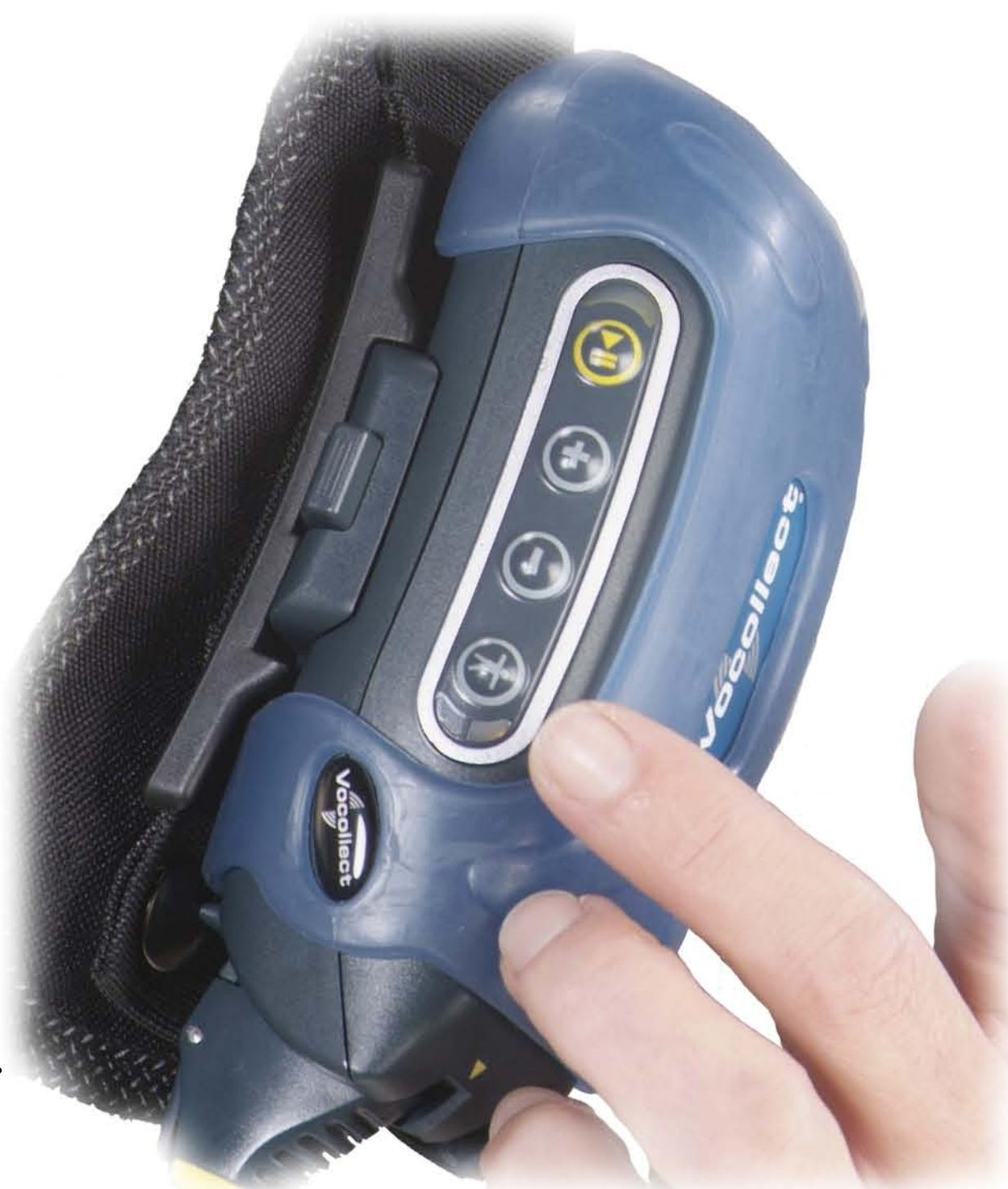
**5.** Uložte nové nastavení stisknutím tlačítka operátora.
