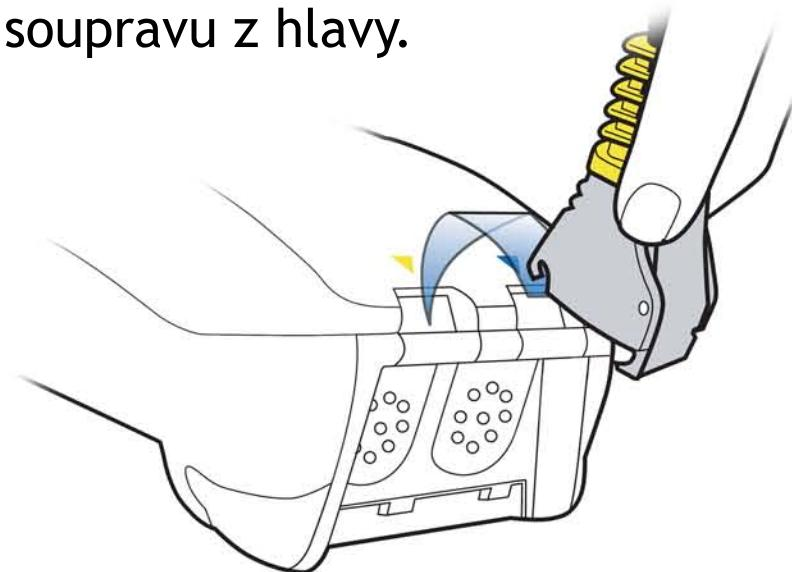
4. Vložte terminál do některé z pozic nabíječky tak, aby tlačítka terminálu směřovala vzhůru a doleva.
