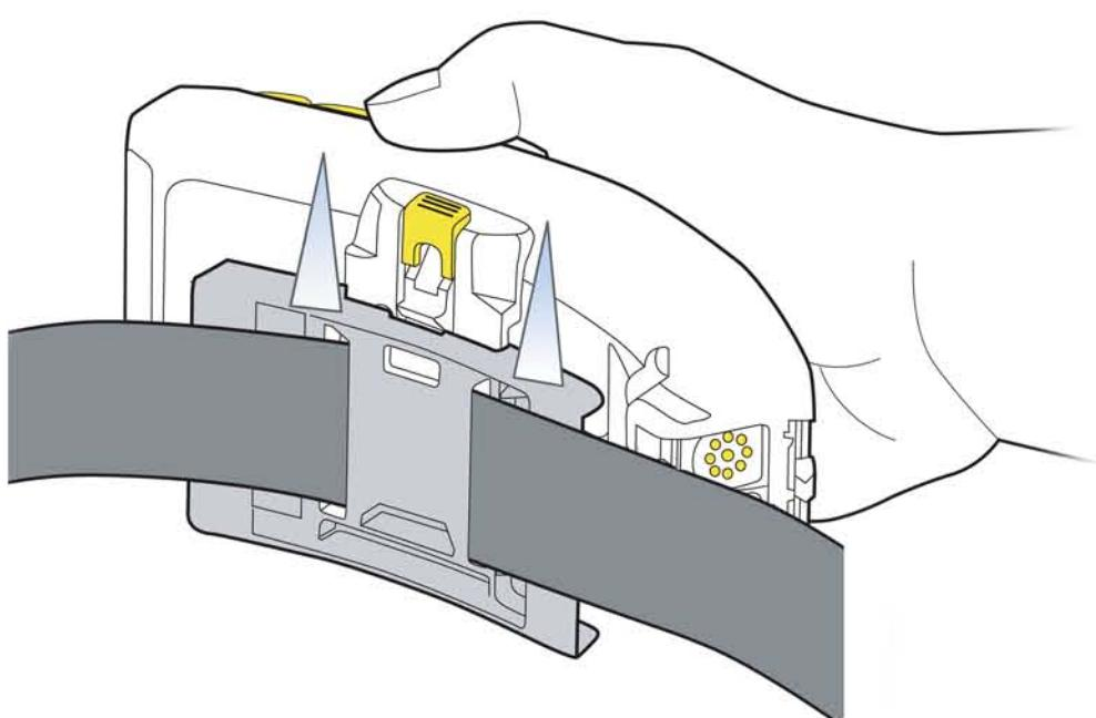
3. Uchopte konektor, nikoliv kabel, a stiskněte uvolňovací páčku. Vyklopte spodní část konektoru směrem z terminálu. Vyjměte konektor z terminálu směrem vzhůru. Uvolněte spony kabelu náhlavní soupravy z oděvu. Otočte ramínko mikrofonu vzhůru a sejměte náhlavní soupravu z hlavy.
