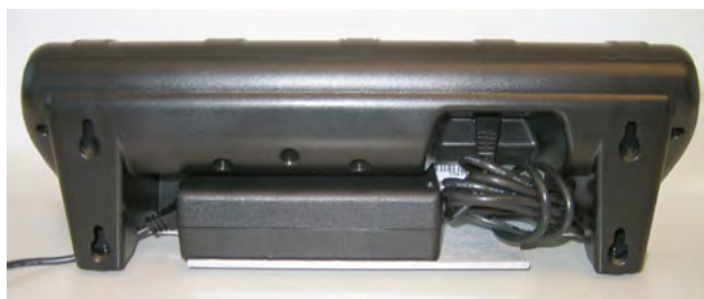
Figura 75: Sursă de alimentare conectată la încărcător
