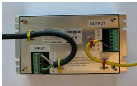
Figura 18: Cabluri atașate la sursa de alimentare
