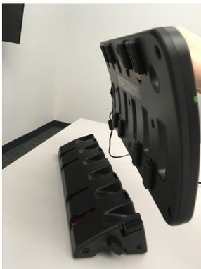
3. Fije el soporte de la banda para la cabeza en el cargador tirando de él en la dirección opuesta y alinee el soporte con las muescas y los orificios de la estación de carga. La curva del soporte de la banda para la cabeza debe coincidir con la curva del cargador en ambas configuraciones.
