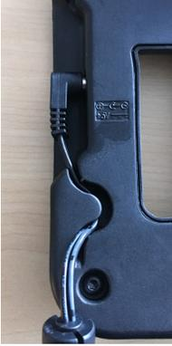
3. Fije el soporte de la banda para la cabeza en la estación de carga tirando de él en la dirección opuesta y alinee el soporte con las muescas y los orificios de la estación de carga. La curva del soporte de la banda para la cabeza debe coincidir con la curva del cargador.
