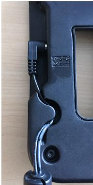
2. Alinee las muescas de la parte inferior del cargador con los orificios de la estación de carga y deslice el cargador hacia la estación de carga. La luz LED permanecerá en la esquina superior izquierda del cargador.
