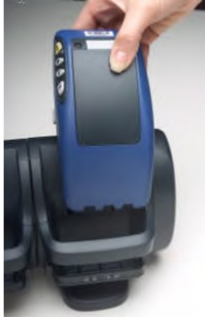
شكل رقم 53: وضع جهاز التوكمان T2 Series في الشاحن
