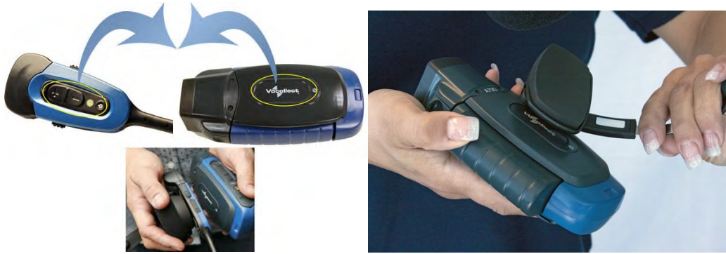
شكل رقم 68: استخدام تقنية الاتصال بالتلامس TouchConnect لإقران سماعة SRX2 بجهاز A700
